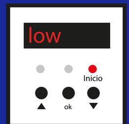
Nota: Una vez que la prensa sea programada colocará una frase "low", esta se refiere a que la temperatura está "baja" y debe a la temperatura a la cual fue programada, cuando la prensa llega a su temperatura esta dará "pitidos" y se desactivarán bajando el pistón.
