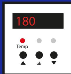
Al presionar por 3ra vez el botón ok, se puede cambiar el tiempo, ajustando con las flechas "arriba", "abajo"
