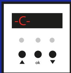
Al presionar por 2da vez el botón ok, se puede cambiar la temperatura, ajustando con las flechas "arriba", "abajo"
