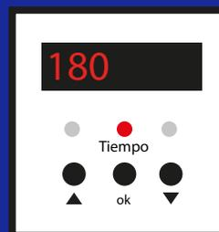
Al presionar por 4ta vez el botón ok, se guardan todos los parametros y la prensa esta lista para ser usada.
