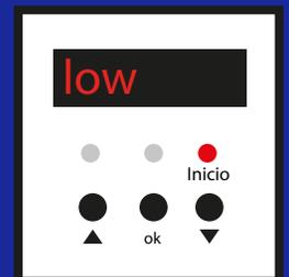
Nota: Una vez que la prensa sea programada colocará una frase "low", esta se refiere a que la temperatura está "baja" y debe a la temperatura a la cual fue programada, cuando la prensa llega a su temperatura esta dará "pitidos" y se desactivará bajando el pistón.
